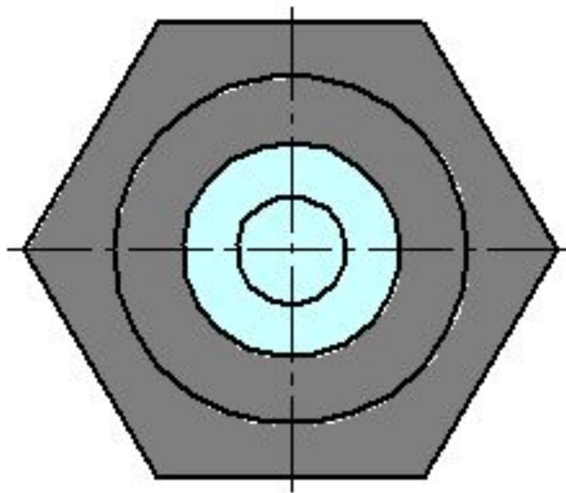
Рис. 165. Соединение половин вида и разреза
