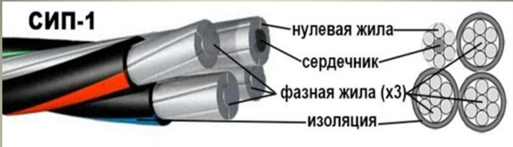
Провод СИП (самонесущий изолированный провод) представляет собой жгут скрученный из изолированных фазных жил, сделанных из алюминия и нулевой несущей жилы. Фазные жилы оснащены изоляцией, сделанной из светостабилизированного полиэтилена повышенного давления окрашенного в черный цвет, который обладает устойчивостью к ультрафиолетовым излучениям. В центре нулевой жилы находится стальной сердечник, скрученный вокруг алюминиевыми проволоками.
