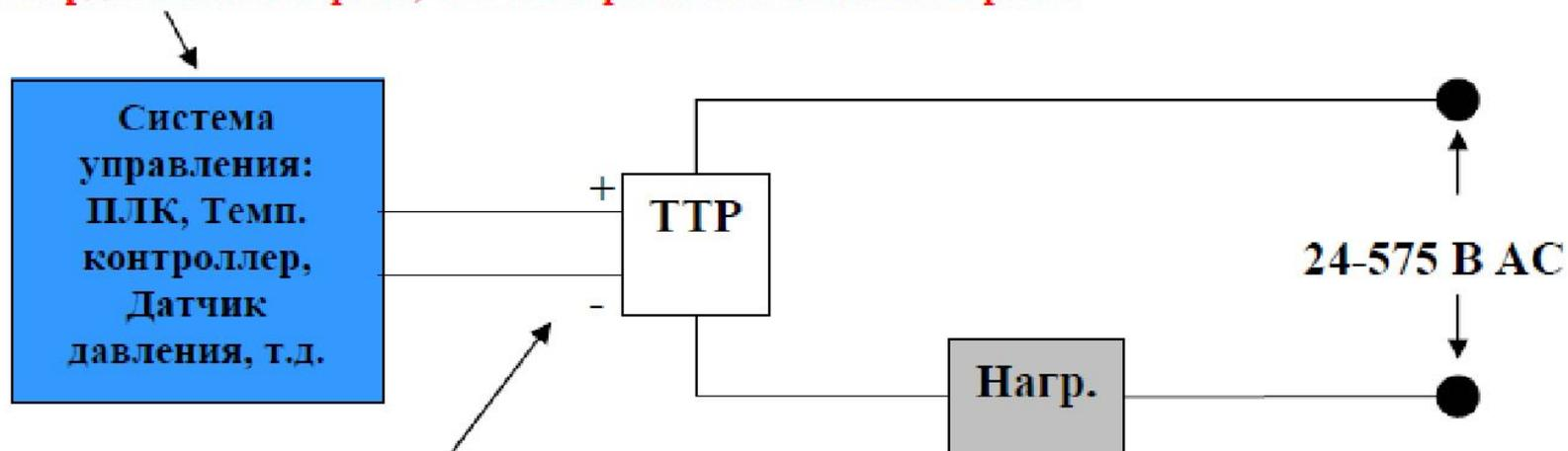
Система управления может подавать сигнал управления на твердотельное реле.
