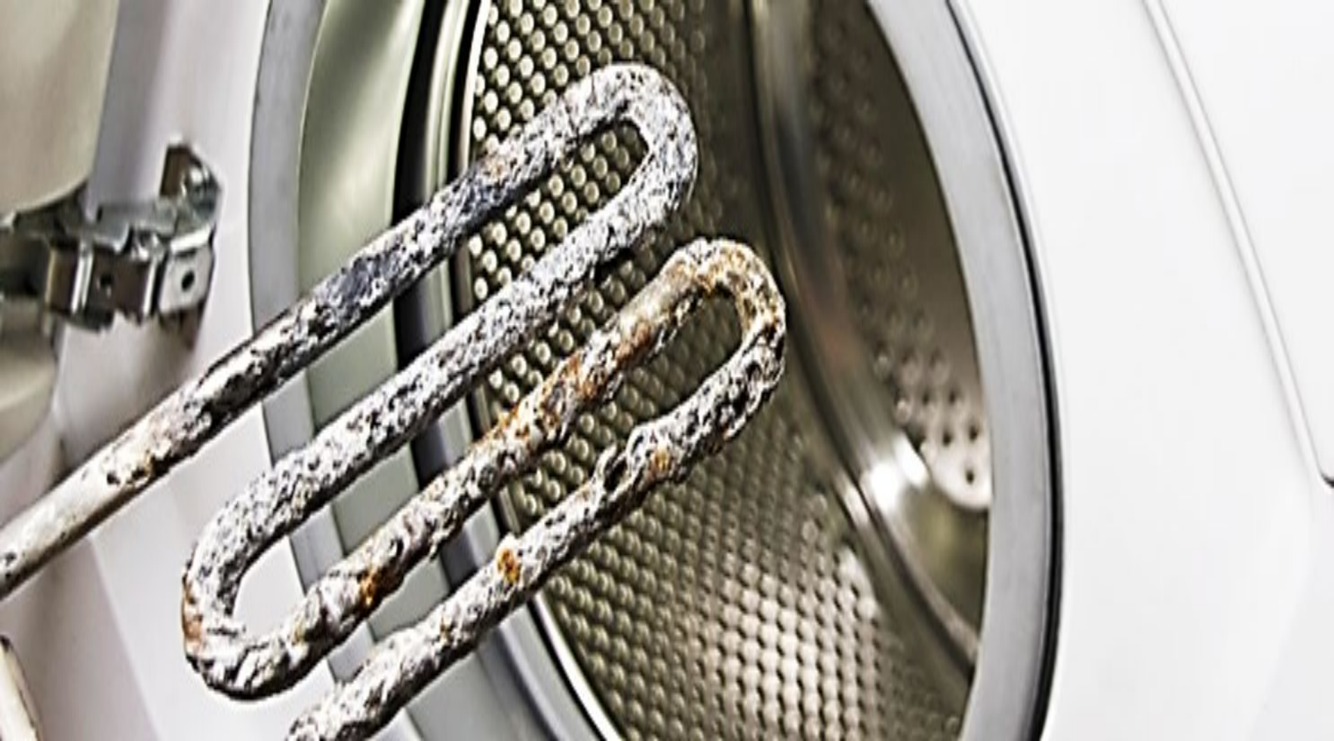
Пример накипи в стиральной машине
