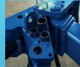
Бесшовная усиленная рама из стали 35, обеспечивает легкость конструкции высокую прочность и длительный срок службы.
