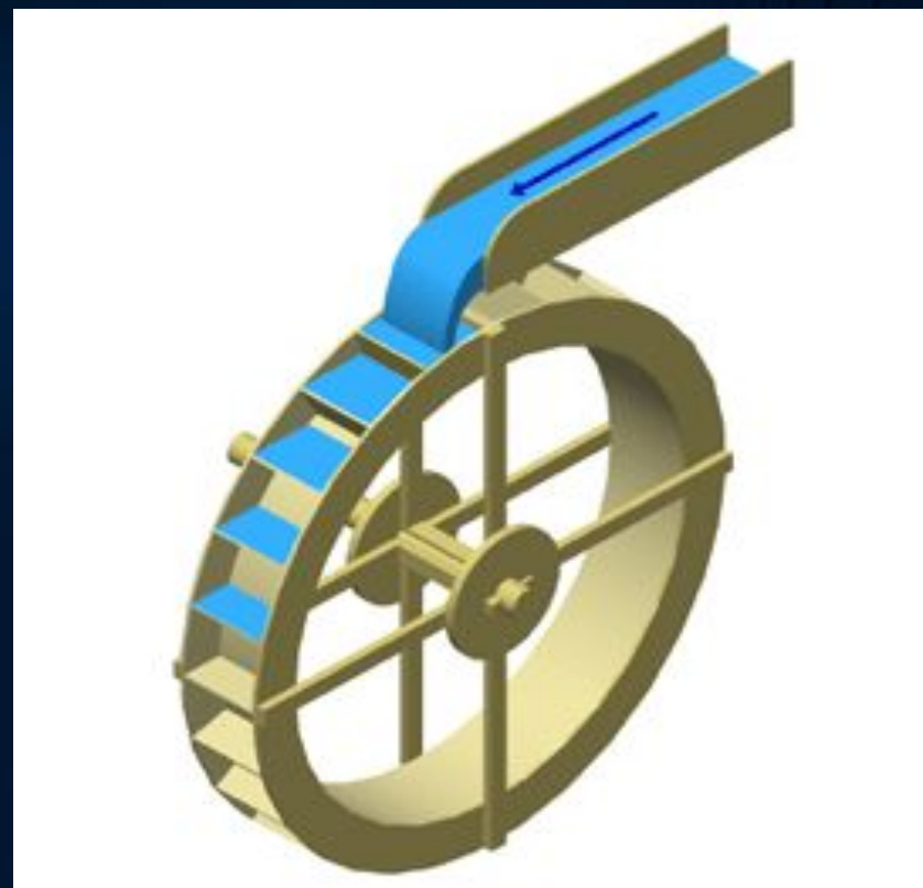
Верхненаливное водяное колесо
