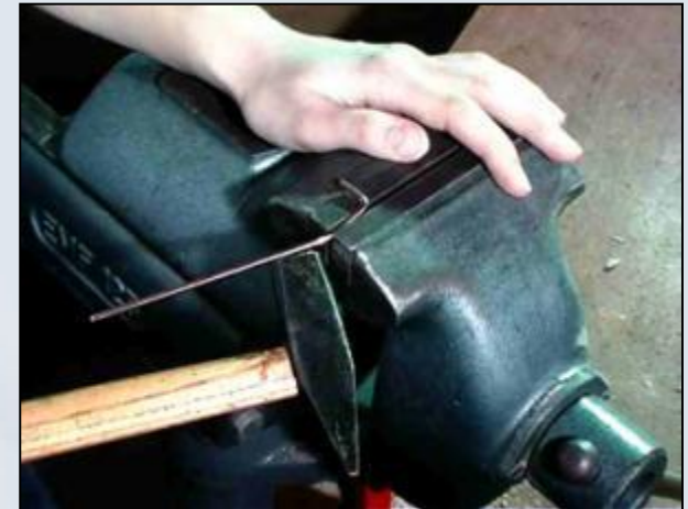
Изготовление крючка из проволоки
