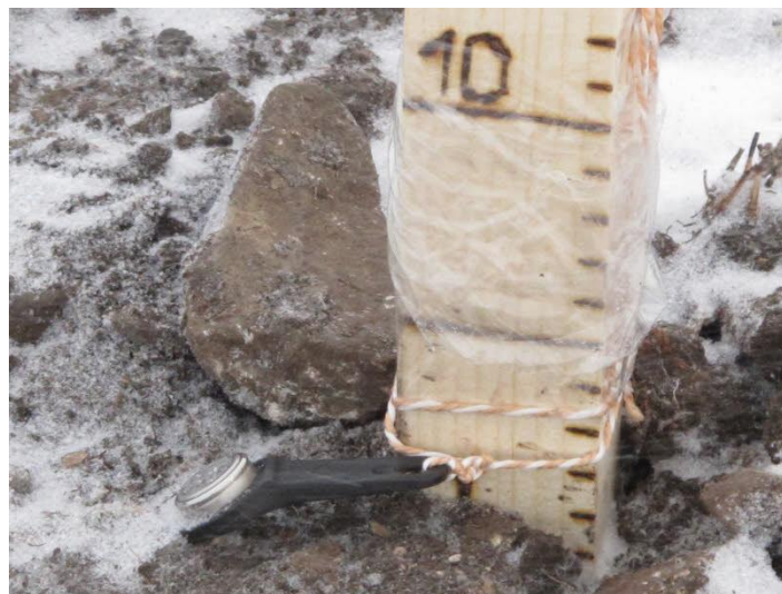
Мобильный регистратор температуры. зафиксированный на снегомерной рейке, («Буртинская степь», декабрь 2014 г.)
