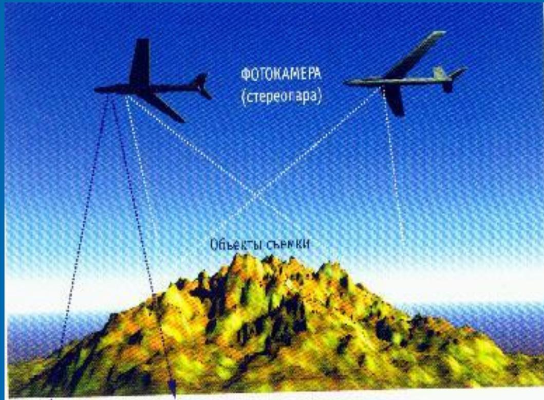
Аэрофотосъемка выполняется камерой МРБ –152, (пленка СН-15), установленной на самолете Ту-134. Масштаб залета 1:60000.
