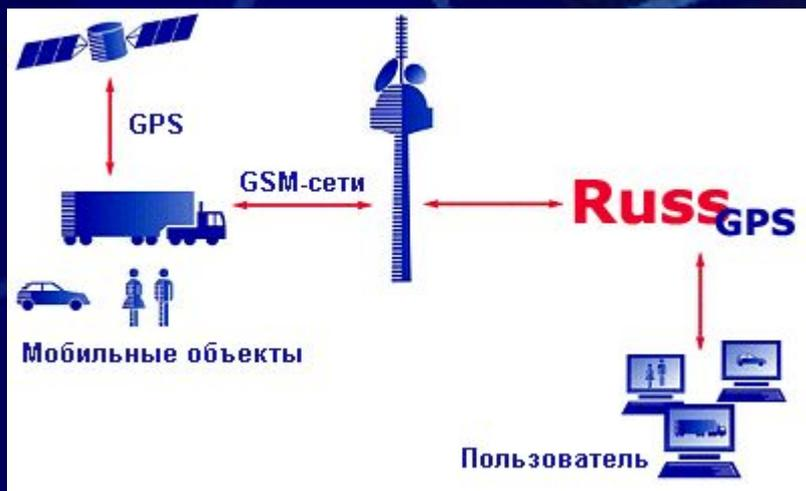
GPS – система спутников наблюдения (24 спутника на орбите);
