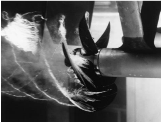
Кавитационный след гребного винта
