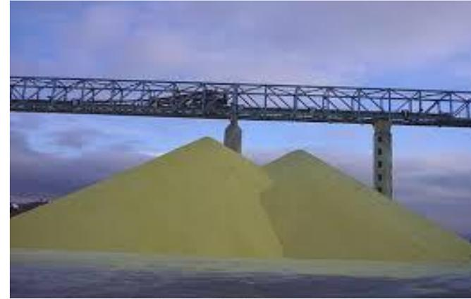
Производство гранулированной серы в Тенгизе
