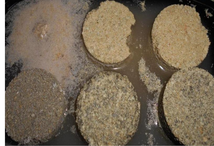
В Западном Казахстане дорогостоящий привозной щебень и песок, которые являются основными компонентами в дорожных конструкциях, предлагается заменить на местный малопрочный щебень и песок из известняка-ракушечника, упрочненные объемной пропиткой раствором КТС.
