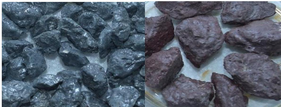
Наполнение габионов блоками и щебнем из известняка-ракушечника пропитанными расплавом серы для строительства дамб и плотин в зонах подтопления.
