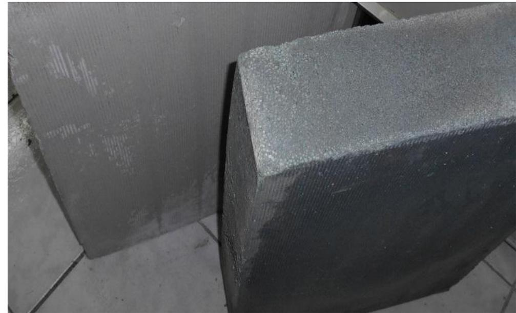
В условиях промышленного производства раствором КТС пропитаны железобетонные бетонные бордюры, водопропускные кольца, газобетонные и пенобетонные блоки.
