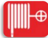
Обозначение место нахождения пожарного крана
