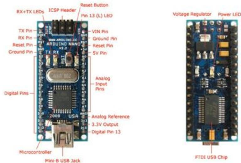
Рис 4 Внешний вид микроконтроллерной платы Arduino Nano V3.
