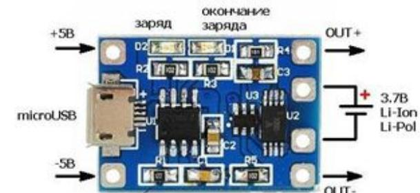
Рис. 3 Внешний вид контроллера заряда-разряда Li-Ion аккумулятора TP4056.
