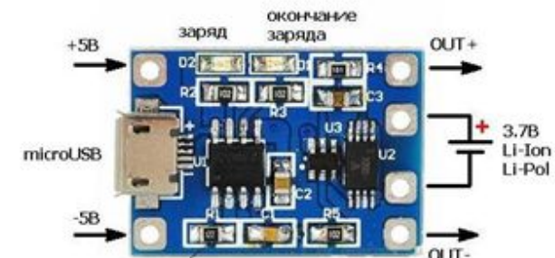
Рис.3 Внешний вид контроллера заряда-разряда Li-Ion аккумулятора TP4056.
