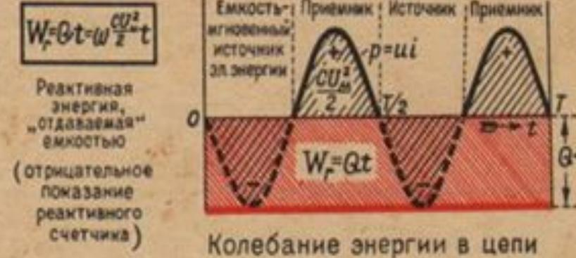
Зарядный ток конденсатора зависит от скорости нарастания напряжения. Поэтому ток в емкости опережает напряжение по фазе на  $\frac{1}{4}$  периода.
