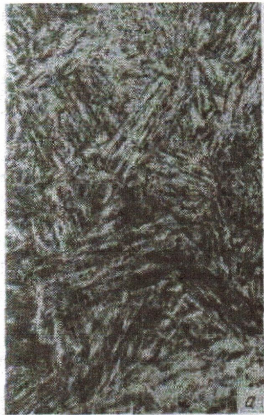
Структура закаленной среднеуглеродистой стали 0,45 % С (мартенсит)
