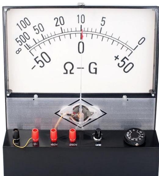
*Омметр – это прибор, объединяющий в одном корпусе миллиамперметр магнитоэлектрической системы, источник питания и шкалу, проградуированную в единицах сопротивления.*
