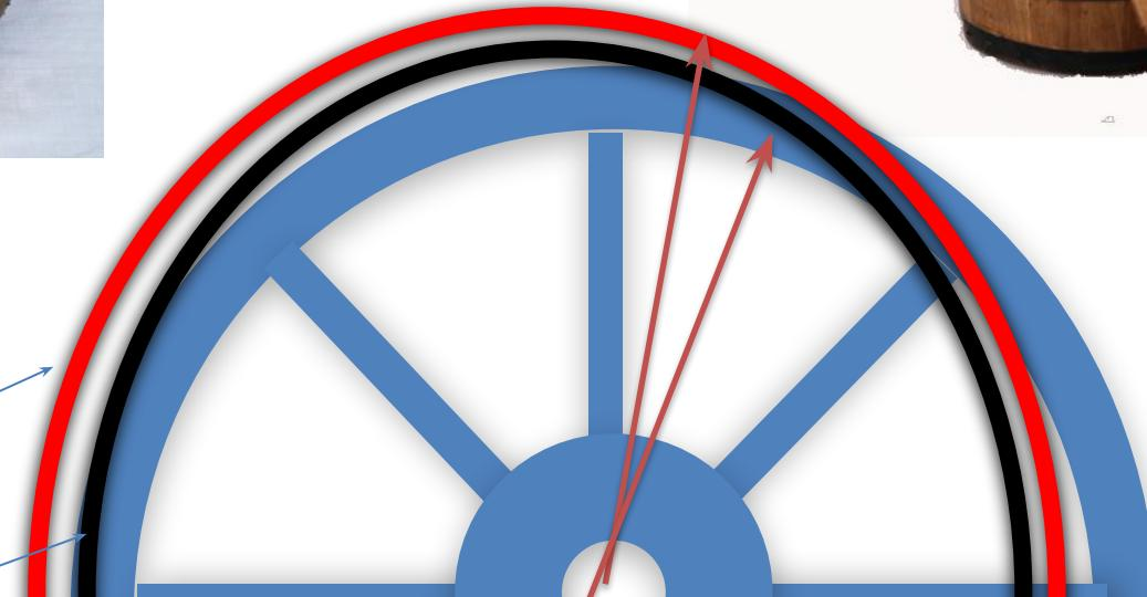
Примером использования свойств тел сужаться при охлаждении может служить известный прием натягивания раскаленных железных шин (обручей) на обод тележного колеса. Когда шина остынет, она станет меньше и плотно обхватит обод.
