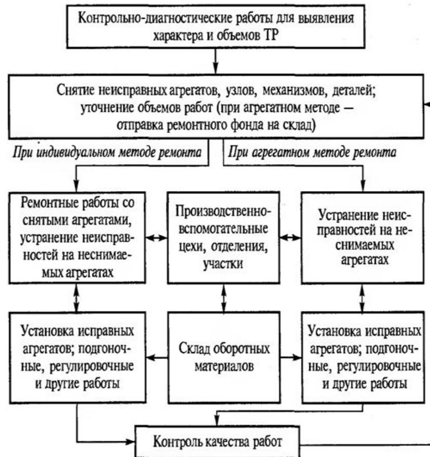
Рисунок 3.2 – Технологическая схема ТР машин на объекте технического перевооружения
