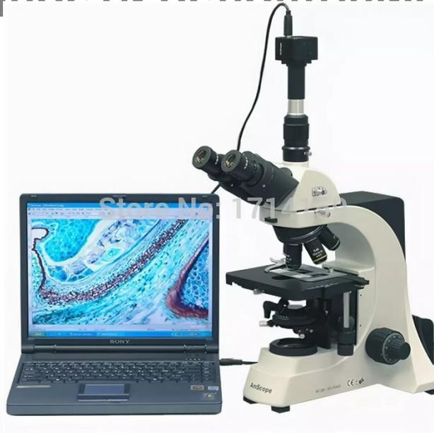
Цифровой микроскоп – вид интерактивного оборудования, состоящего из оптической либо электронно-лучевой системы получения данных (собственно микроскоп) и системы кодирования изображения (цифровая камера).
