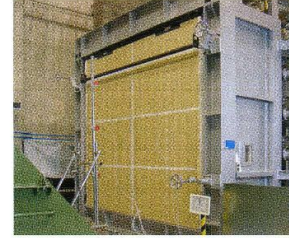
Испытания по огнестойкости стен
