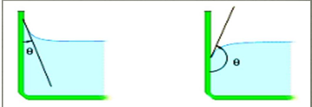
**Рис. 5, а, Поверхность смачивающей жидкости у стенки сосуда**
