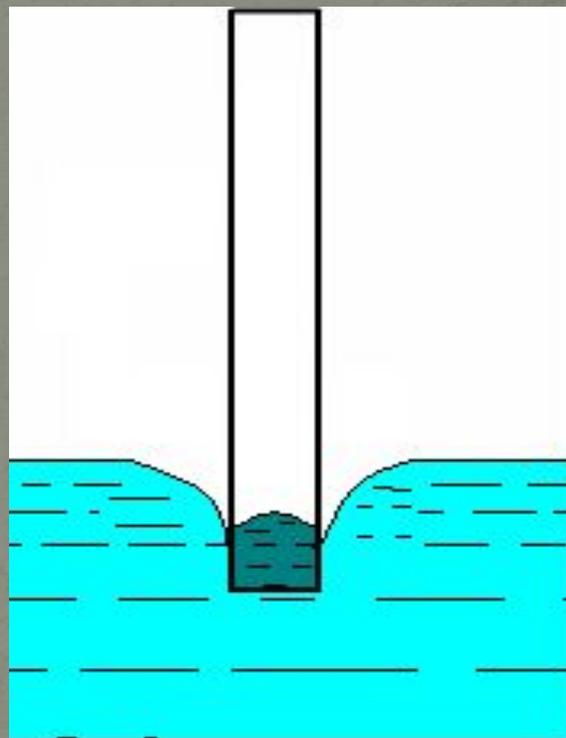
*Жидкость. Капиллярное поднятие в узкой трубке.*
