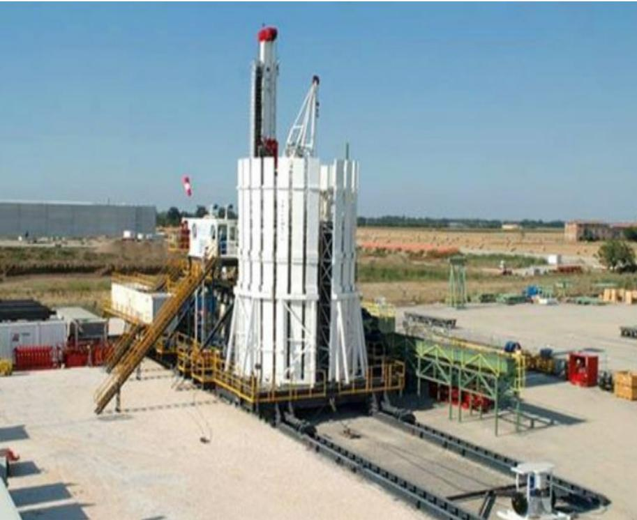
Автоматизированная буровая установка гидравлического типа NN-300
