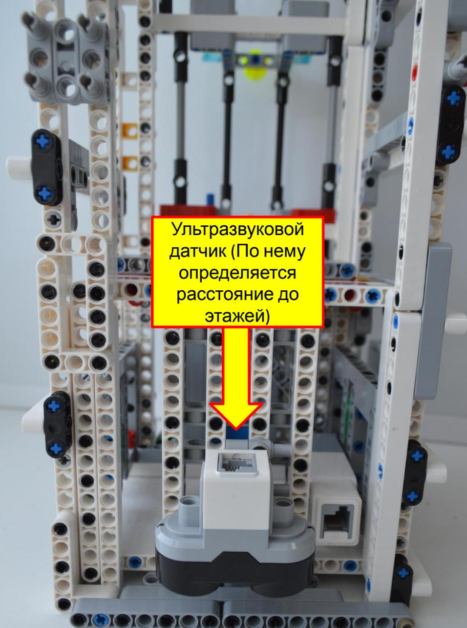
Ультразвуковой датчик (По нему определяется расстояние до этажей)
