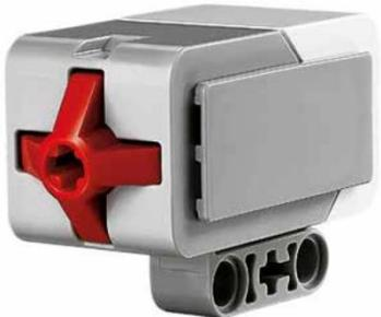
Датчик касания (По его нажатию лифт поднимается на 1 уровень ниже)
