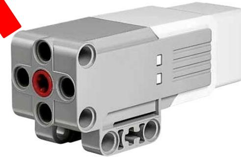
Средний мотор (Поднимает и опускает лифт)
