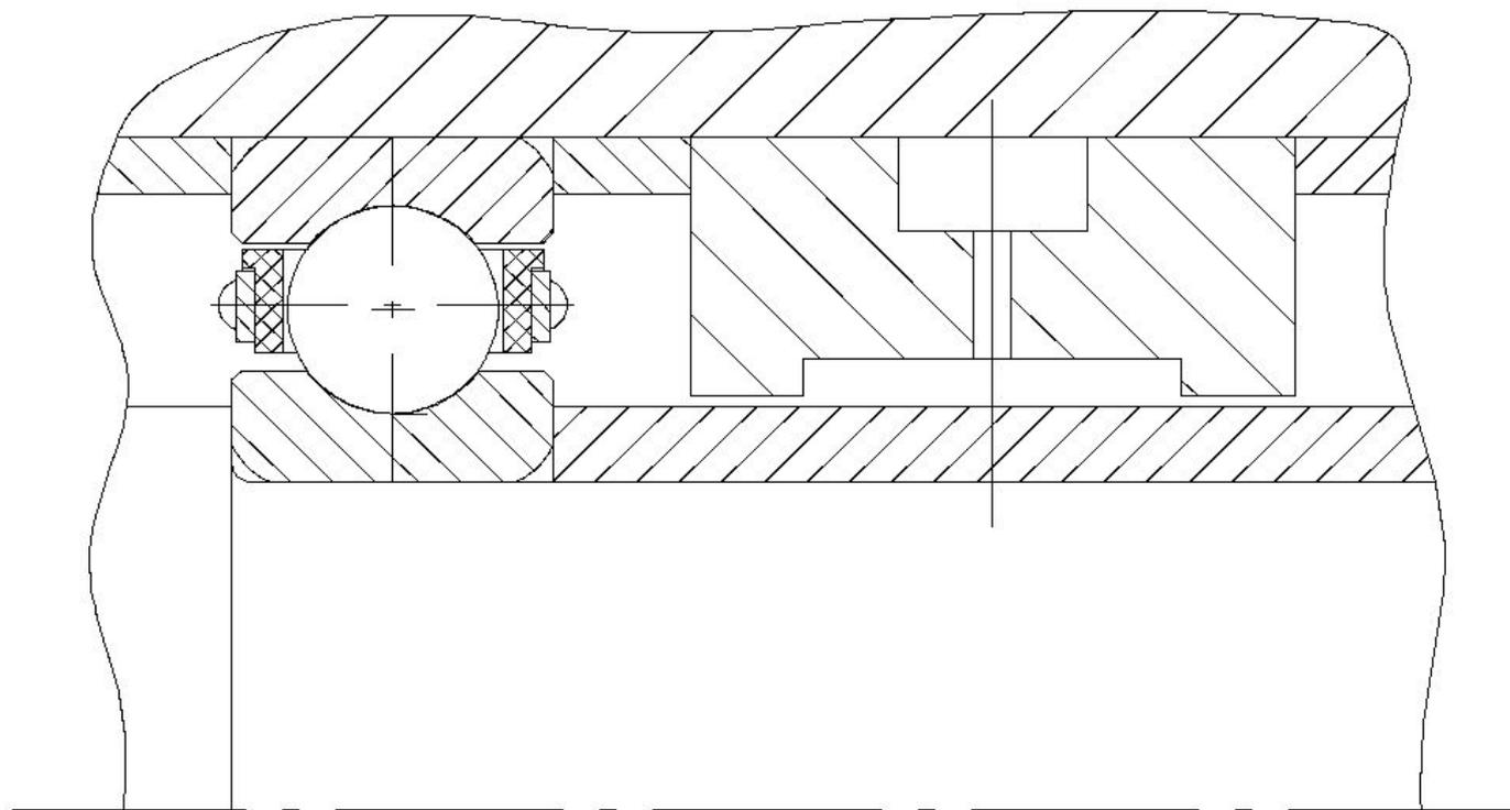
Комбинированный подшипник с параллельным распределением нагрузки
