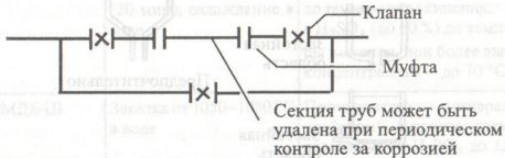
Рис. 5.8. Возможность контроля за коррозионным процессом
