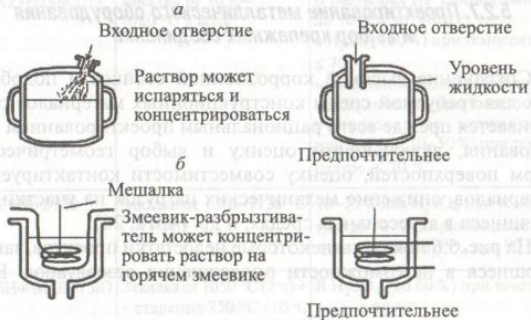
Рис. 5.7. Предотвращение испарения и концентрирования растворов
