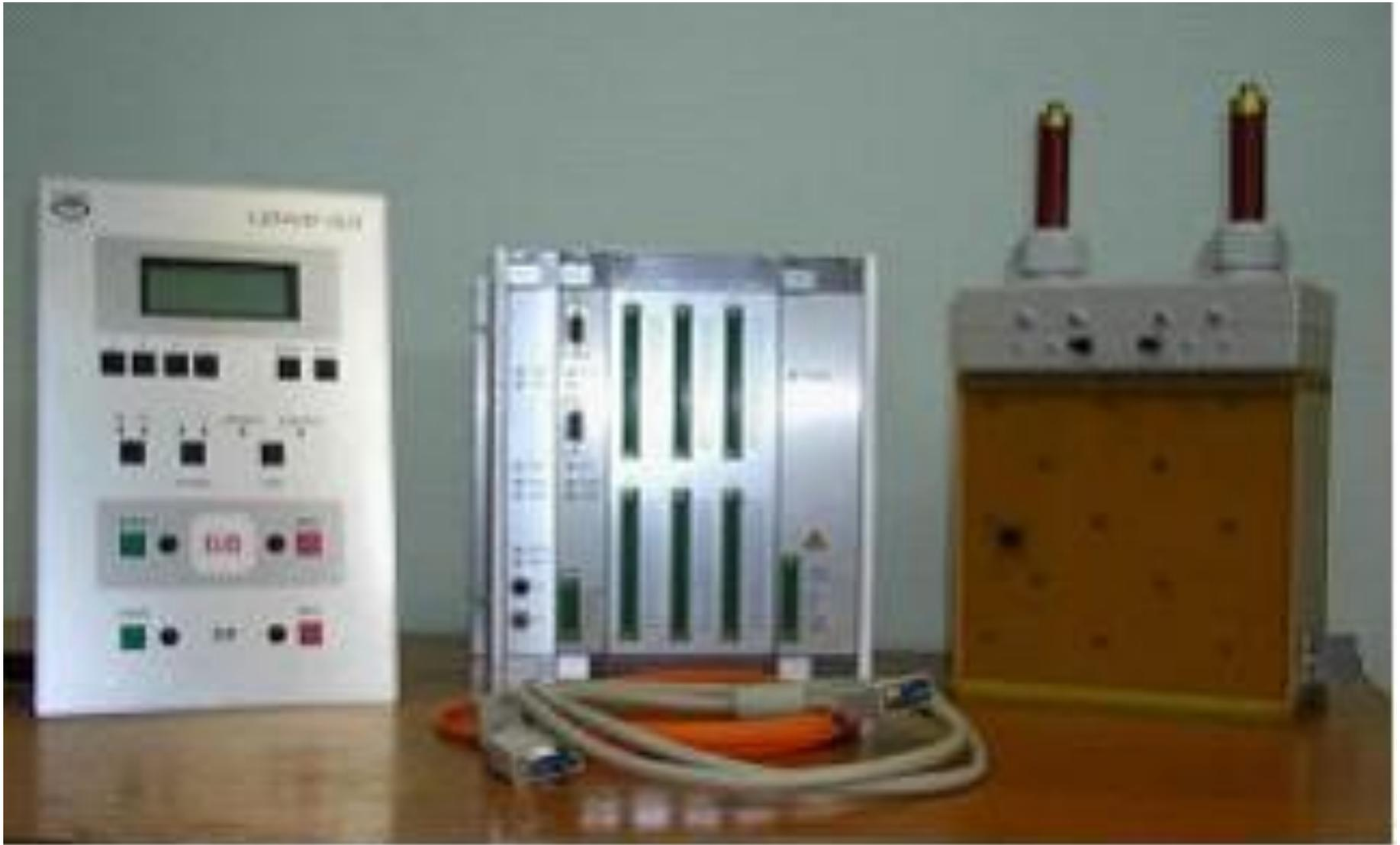
*Рисунок – Внешний вид цифрового устройства защиты ЦЗАФ-3,3*
