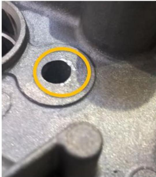
В зависимости от размера заусенца, след от доработки может быть разного размера, но!
