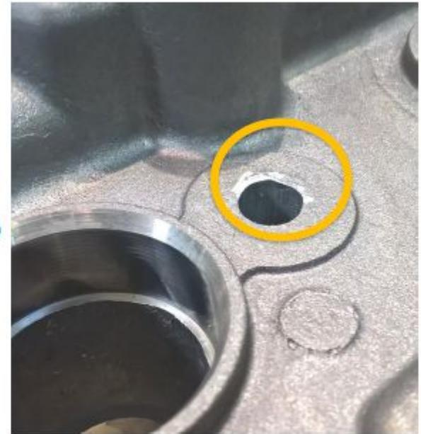
Данный след не приводит к потери товарного вида, так как последующая сборка полностью скрывает его
