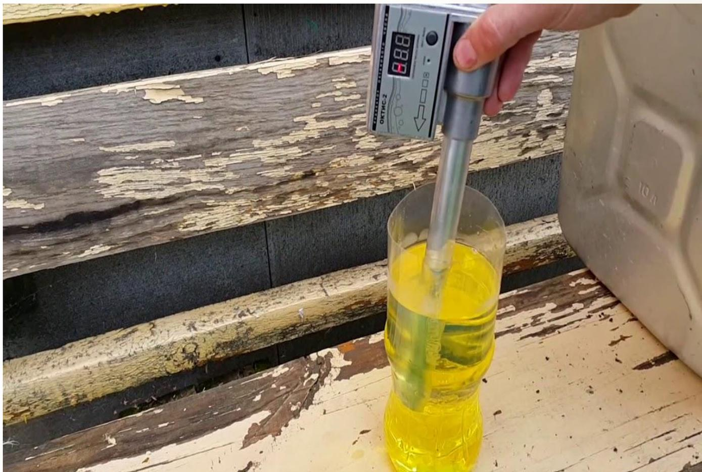
**Октáновое числó (от [изо]октан) — показатель, характеризующий детонационную стойкость топлива (способность топлива противостоять самовоспламенению при сжатии) для двигателей внутреннего сгорания. ... Стук в двигателе на слух воспринимается как характерный металлический звон.**
