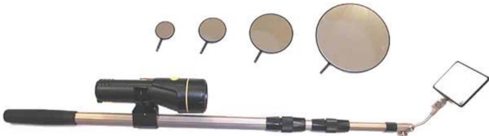
Досмотровое устройство "Перископ-165" - отечественная разработка, предназначенная для визуального досмотра транспортных средств, грузов, труднодоступных и плохо освещенных мест в помещениях. "Перископ-165" состоит из телескопической углепластиковой штанги и набора сменных зеркал различной площади и конфигурации. Длина штанги регулируется в пределах от - 550 мм (транспортное положение) до - 1650 мм. Вес устройства - 0,3 кг.
