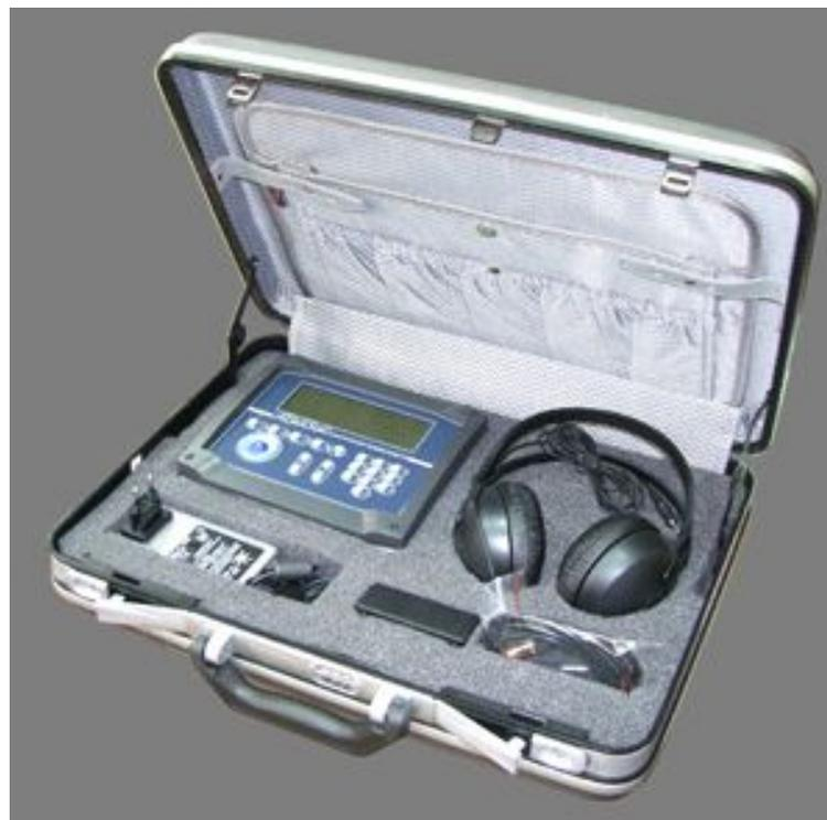
Ионно-дрейфовый детектор (ИДД) «Кербер-Т» предназначен для обнаружения следовых количеств малолетучих и летучих органических веществ, в т. ч. токсичных, аварийно химически опасных веществ (АХОВ), взрывчатых, наркотических в воздухе контролируемых объектов, на поверхности различных предметов, на пальцах и одежде людей.
