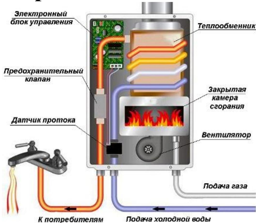
Внешний вид и принцип работы газовой колонки
