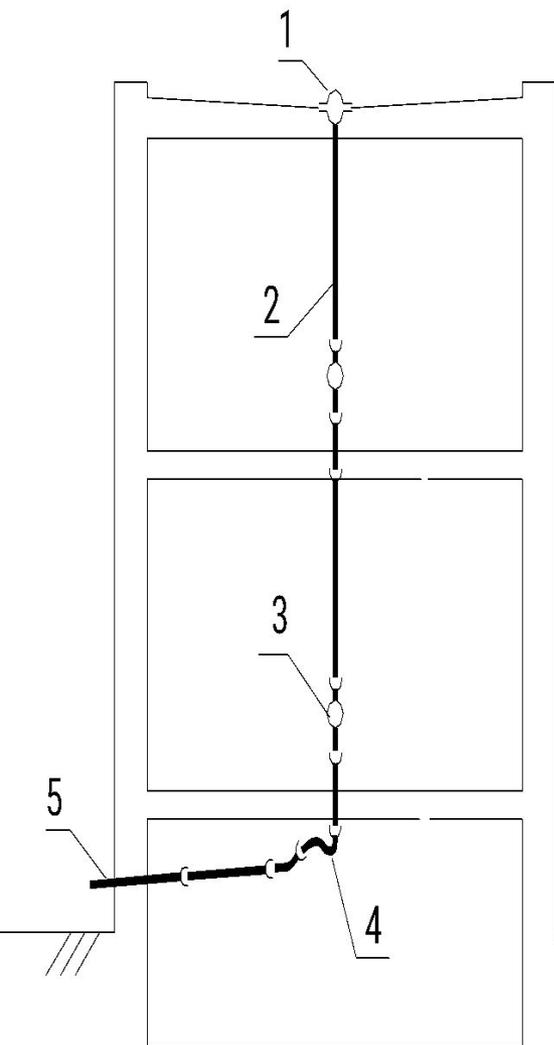
1 - водосточная воронка. Здесь показана воронка колпакового типа, для неэксплуатируемых кровель. Плоские коронки устраиваются для эксплуатируемых кровель. Марка воронки подбирается по её пропускной способности, которая рассчитывается по методике СНиП 2.04.01-85 .
