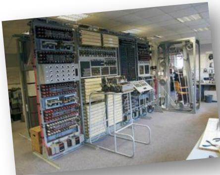
1942-1943 гг. В Англии при участии Алана Тьюринга была создана вычислительная машина "Colossus". В ней было уже 2000 электронных ламп. Машина предназначалась для расшифровки радиограмм германского Вермахта.
