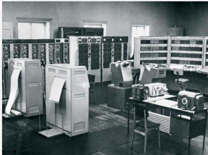
В СССР в 1967 году вступила в строй наиболее мощная в Европе ЭВМ второго поколения “БЭСМ-6” (Быстродействующая Электронная Счетная Машина 6). Также в то же время были созданы “Минск-2”, “Урал-14”. Появление полупроводниковых элементов в электронных схемах существенно увеличило емкость оперативной памяти, надежность и быстродействие ЭВМ. Уменьшились размеры, масса и потребляемая мощность.
