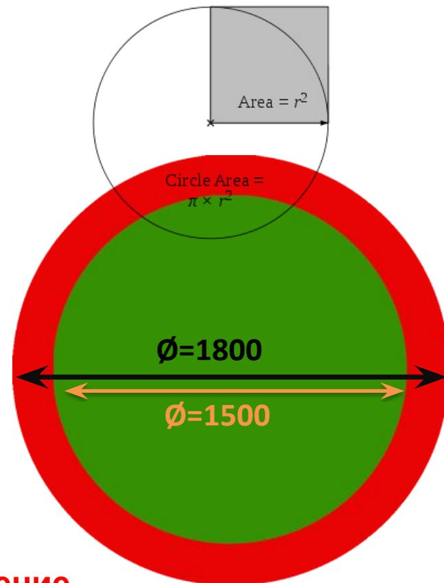
Расчеты показывают, что диаметр двигателя может быть уменьшен с 1800 мм до 1500-1400 мм
