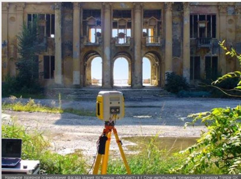
Наземное лазерное сканирование фасада здания гостиницы «Инттурист» в г. Сочи импульсным трехмерным сканером Trimble SX
