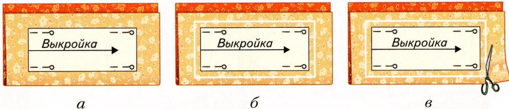
Рис. Операции раскроя: а – прикалывание выкройки; б – обмеловка; в – выкраивание детали
