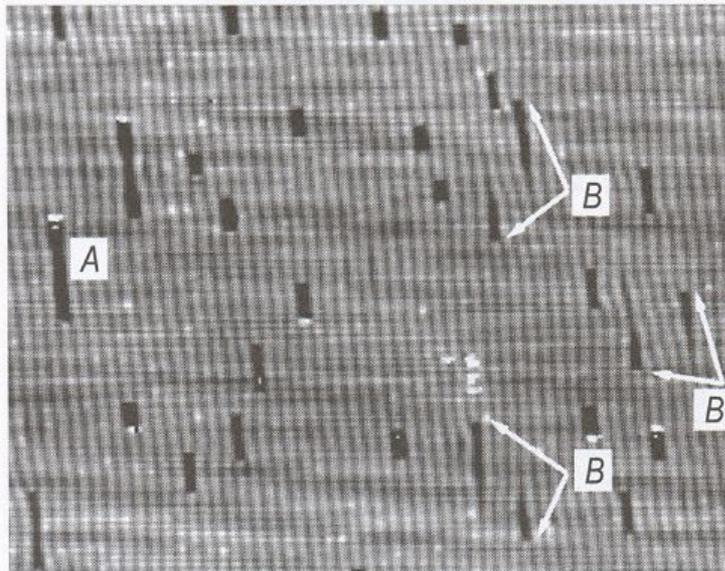
**Рис. 9.21.** СТМ изображение ( $830 \times 830 \text{ \AA}^2$ ) поверхности Au(100) после бомбардировки 0,05 MC ионов  $\text{Ar}^+$  с энергией 600 эВ. Видны два типа дефектов: впадины (A) и индивидуальные 2D дислокации (B). Последние существуют парами, как это помечено стрелками [9.13])
