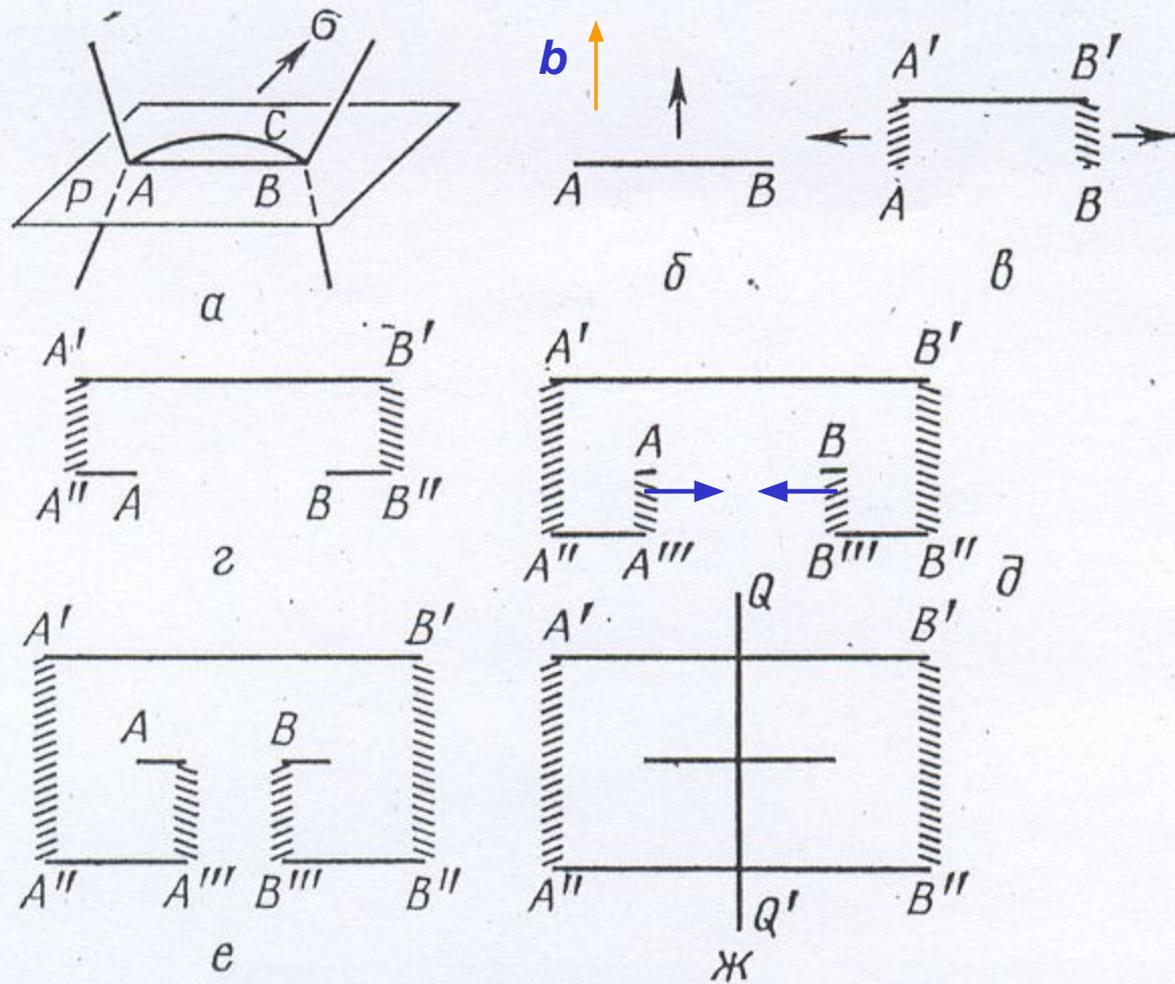
35. Прогибание дислокации, закрепленной в точках  $A, B$ , под действием приложенного напряжения ( $a$ ), схема последовательных стадий работы источника Франка—Рида ( $б—ж$ ):
