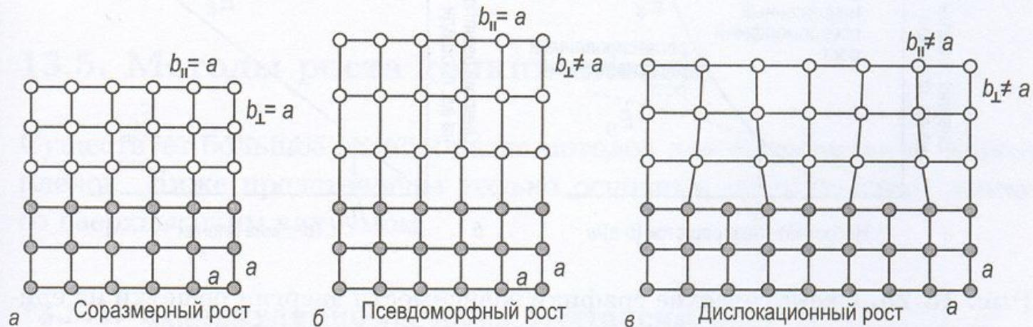
**Рис. 13.24.** Схематическая диаграмма, иллюстрирующая механизмы роста гетероэпитаксиальных пленок,
