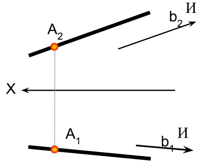
*Эпюром прямой* называется чертеж, состоящий из двух или более ортогональных проекций, связанных между собой
