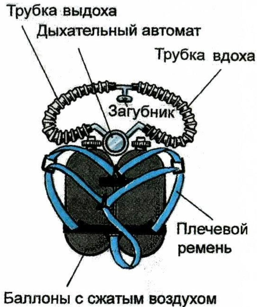
Акваланг позволяет находиться под водой от нескольких минут (на глубине около 40 м) до часа и более (на небольших глубинах). Спуски с аквалангом на глубины более 40 м не рекомендуются т.к. вдыхание воздуха, сжатого до большого давления, может привести к азотному наркозу. У человека нарушается координация движений, мутится сознание.
