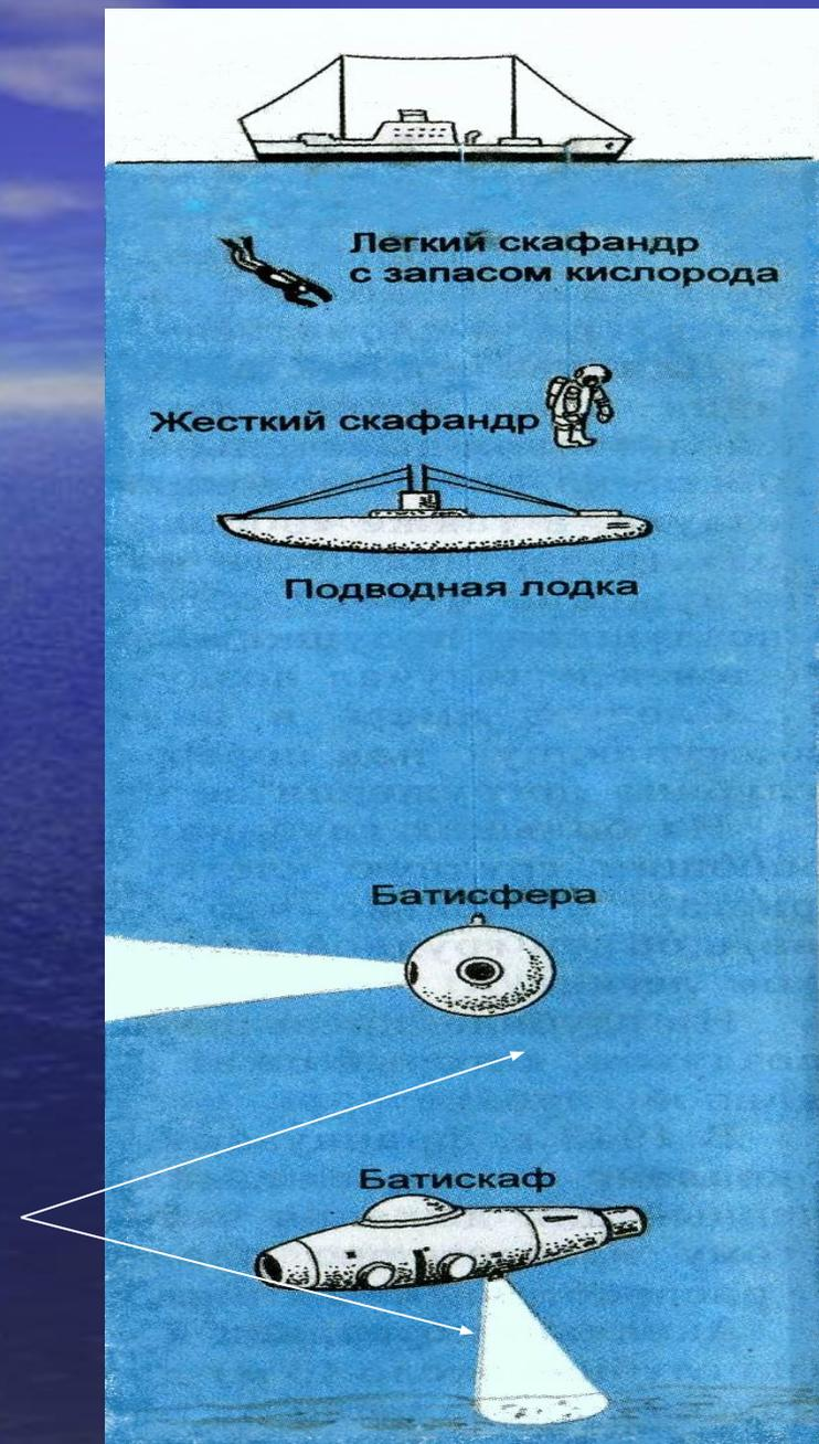
**Батисферу** опускают с надводного судна с помощью троса. Впервые она была использована итальянцем Бальзамелло в 1892 г. Глубина погружения тогда составляла 165 м; впоследствии она превысила 1 км.
