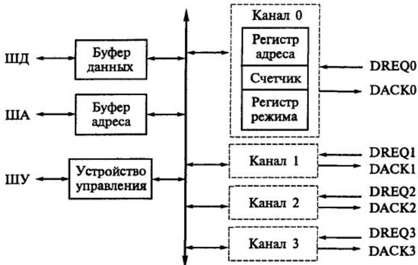
Структурная схема контроллера i8237A
