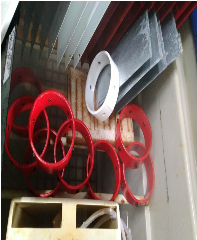
Погружение в камеру соляного тумана
