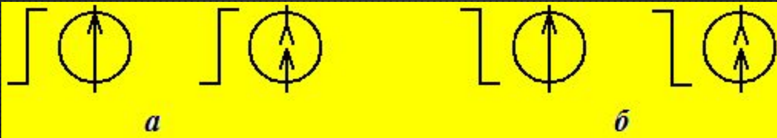
Рисунок 2 – Включение или выключение источников энергии:
