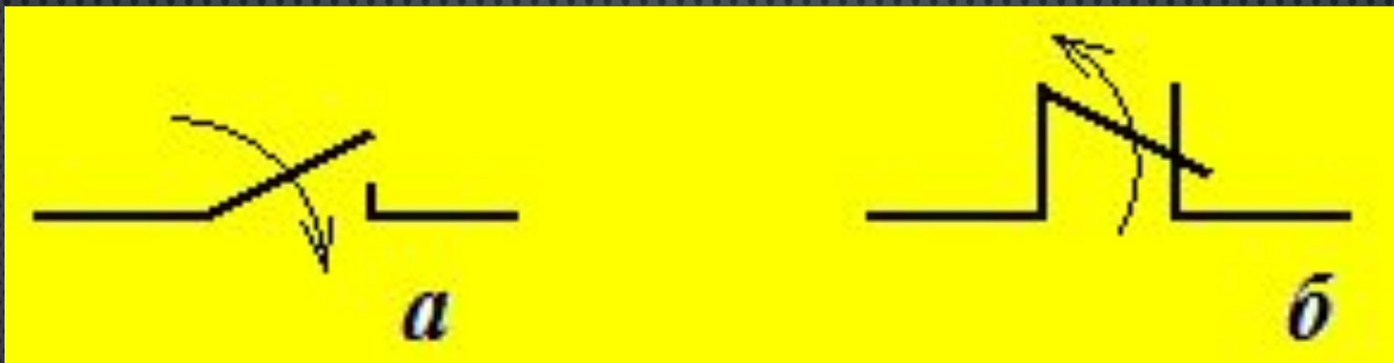
Рисунок 1 – Механическое соединение или разъединение отдельных участков цепи с помощью идеального ключа:
