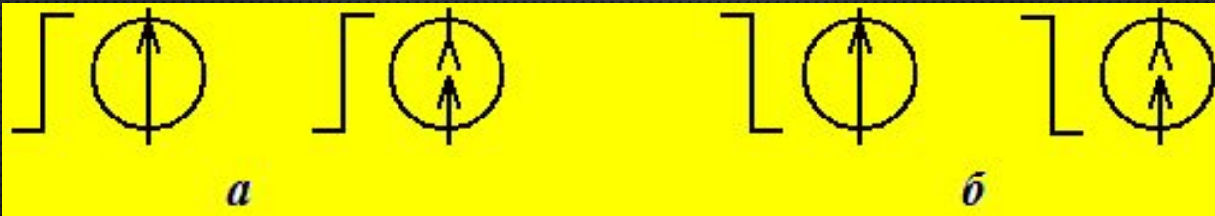
Рисунок 2 – Включение или выключение источников энергии:
