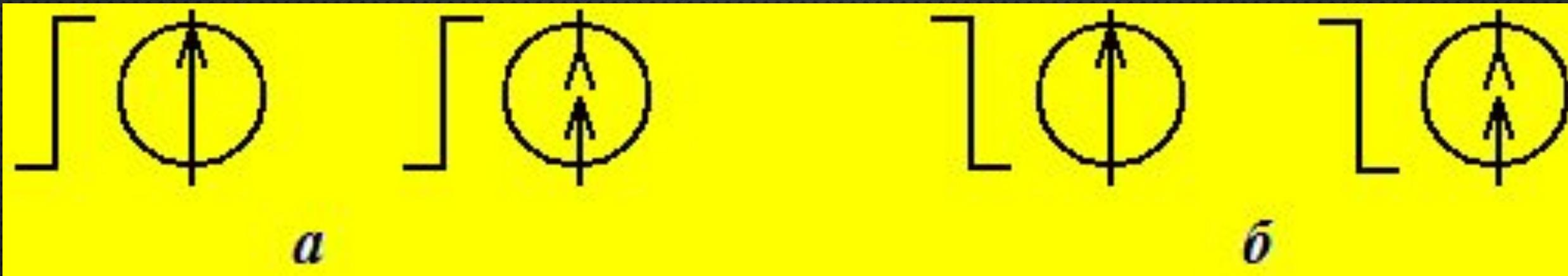
Рисунок 2 – Включение или выключение источников энергии:
