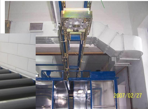
Подвесной конвейер в закрытом профиле
