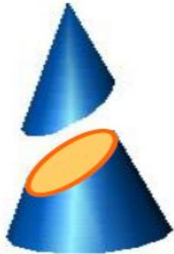
Эллипс получается в том случае, когда угол наклона секущей плоскости меньше угла наклона образующих конуса к его основанию, т.е. когда плоскость пересекает все образующие данного конуса.
