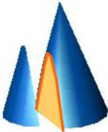
Если секущая плоскость направлена под углом, который изменяется  $90^\circ \geq \beta > \alpha$  делаях , то в сечении получается **гипербола**. В этом случае секущая плоскость параллельна двум образующим конуса. Гипербола имеет две ветви, так как коническая поверхность двухполостная.
