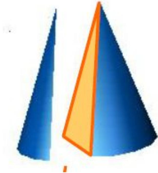
*Если секущая плоскость проходит через вершину конуса, в его сечении получается две прямые образующие (треугольник).*
