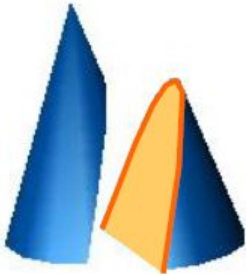
Если углы  $\alpha$  и  $\beta$  равны (то есть секущая плоскость параллельна одной из образующих конуса), в сечении получается парабола.
