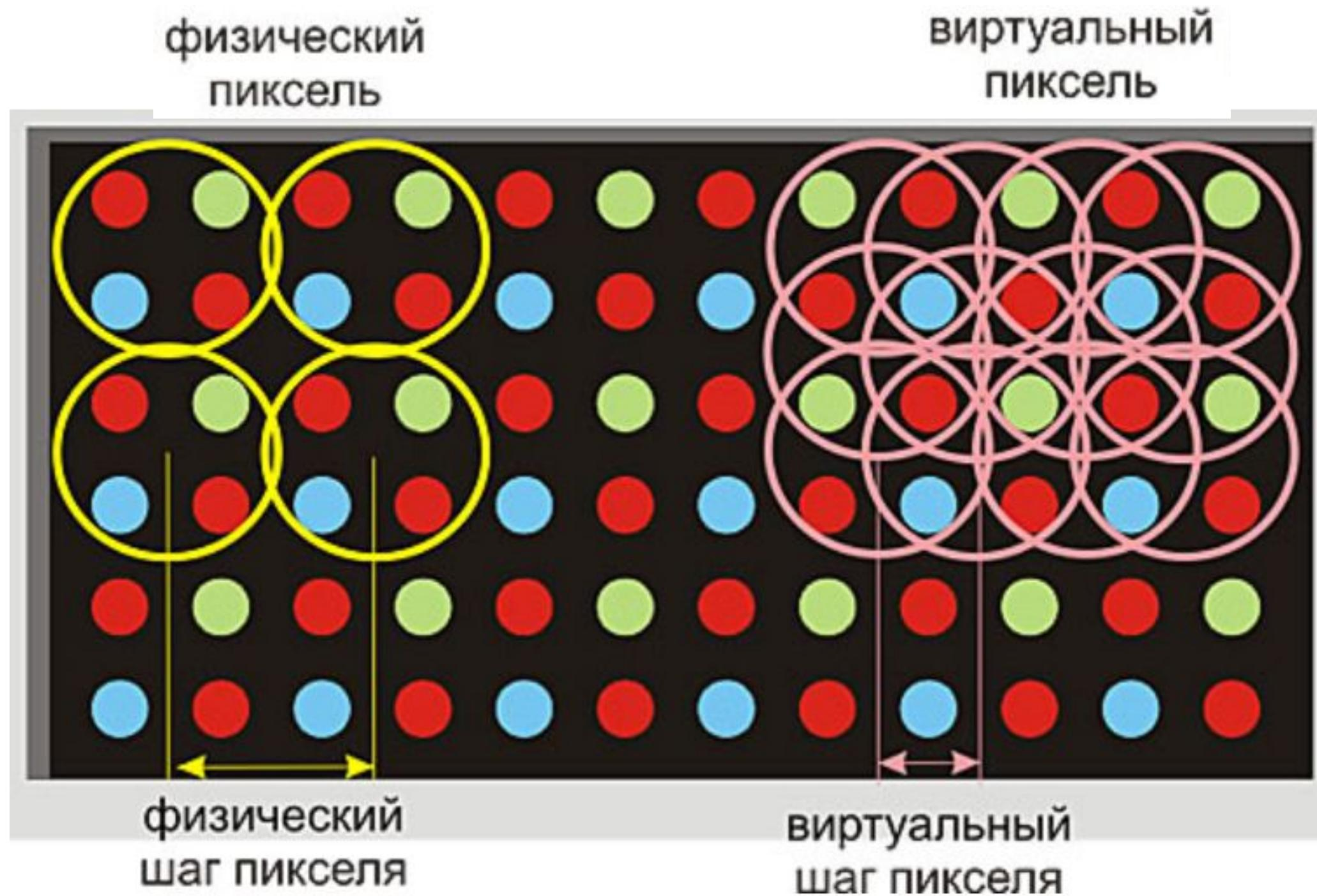
Виртуальный пиксель ситуационен — он охватывает светодиоды, расположенные рядом. Он может совпадать с физическим пикселем и включать тот же набор светодиодных ламп, а может включать в себя светодиоды из соседних физических пикселей.
