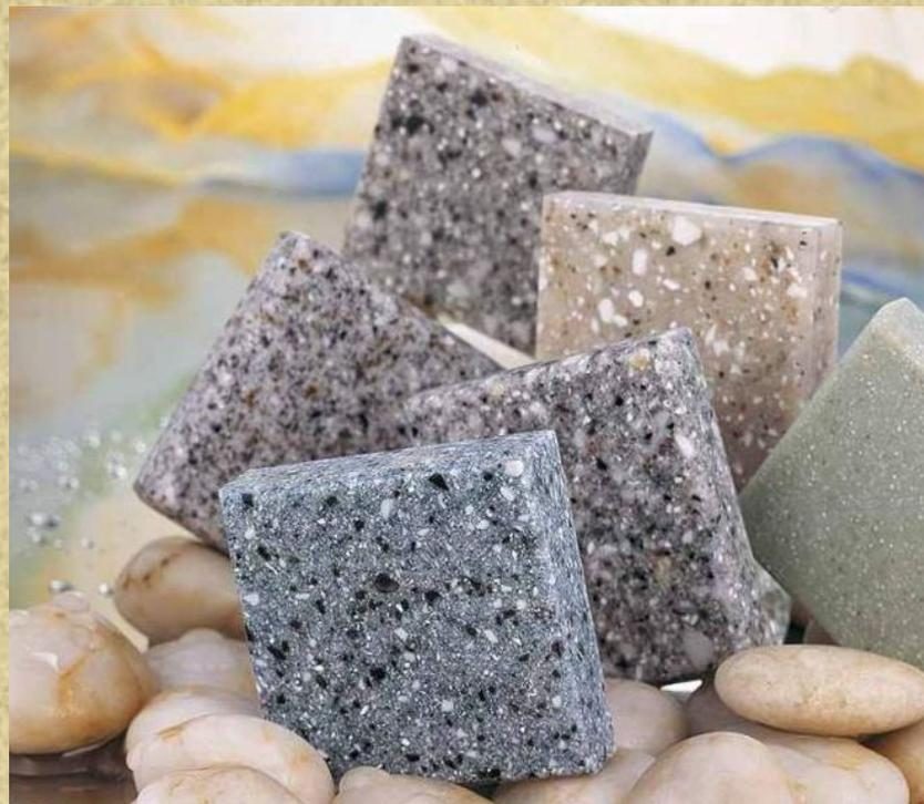
Рисунок 1-Образцы полимербетона.
