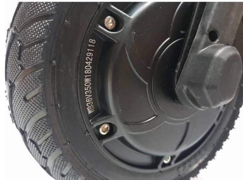
**Мощность мотор-колеса.** Она должна быть 350W. Эту информацию можно увидеть на гравировке мотор-колеса. Плюс надпись должна быть ровная и четкая, а сейчас большинство идет обычных наклеек
