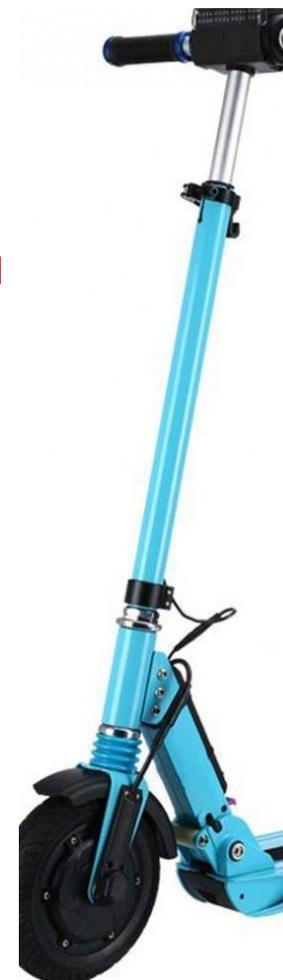
Есть заводы, которые делают **большой язычок складывания и большой задний стоп-сигнал** – это реплики самокатов Kugoo. Механизм складывания у таких самокатов менее надежен (видимо делается из плохого алюминия, и + он полый внутри). Остерегайтесь подделок
