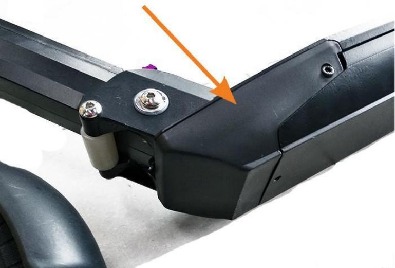
**Крышка,** закрывающая батарейный отсек должна идти внахлест
