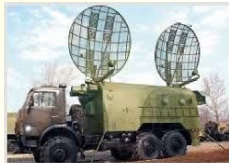
Тропосферная станция Р-423-2
