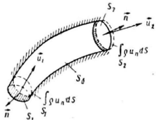
На поверхности  $S_1: u_n = -u_n \Rightarrow \int_{S_1} \rho u_n dS = \int_{S_2} \rho u_n dS$  - гидравлическая форма уравнения неразрывности.
