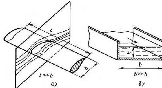
$$\text{Уравнение неразрывности для несжимаемой жидкости } \frac{\partial u_x}{\partial x} + \frac{\partial u_x}{\partial y} = 0 \Leftrightarrow \frac{\partial u_x}{\partial x} = -\frac{\partial u_y}{\partial y} \quad (2).$$
