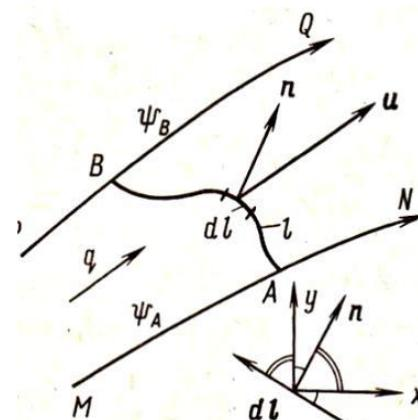
Значит,  $q = \int_A^B (u_x dy - u_y dx) = \int_A^B \left( \frac{\partial \Psi}{\partial y} dy + \frac{\partial \Psi}{\partial x} dx \right) = \int_A^B d\Psi = \Psi_B - \Psi_A = \Delta\Psi$  - расход между двумя линиями тока равен разности значений функций тока на этих линиях.
