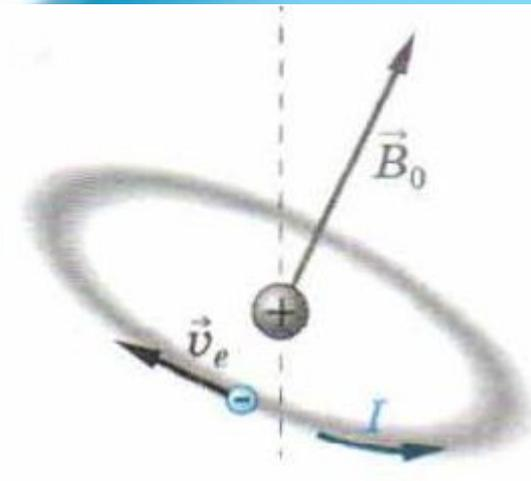
Плоскость орбиты электрона в атоме.  $B_0$  - индукция собственного магнитного поля, созданного орбитальным током  $I$
