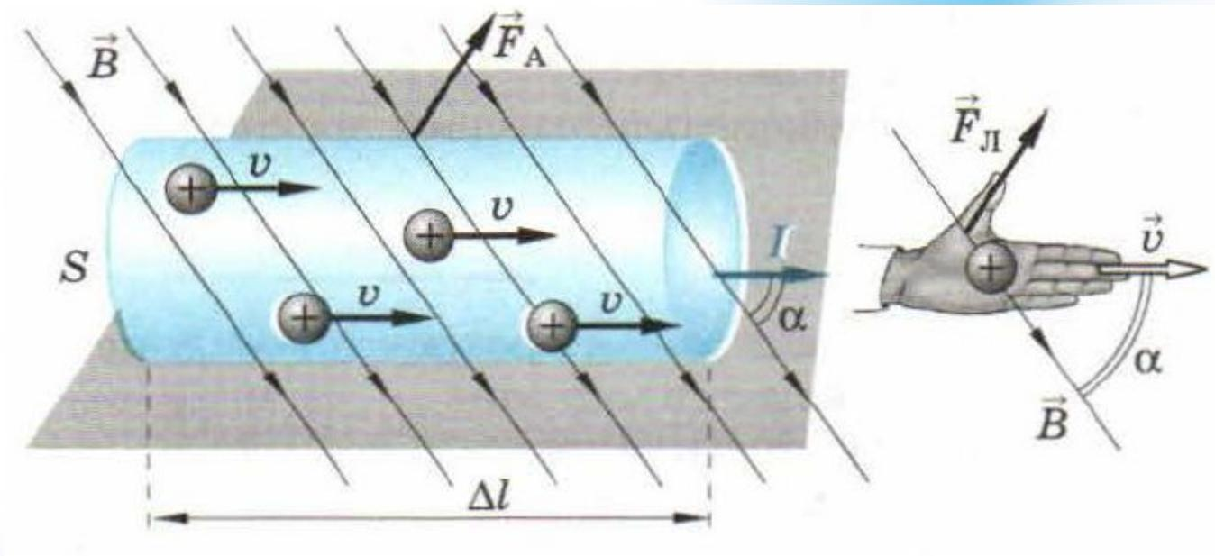
*Сила Лоренца - сила, действующая на движущуюся заряженную частицу со стороны магнитного поля:*
