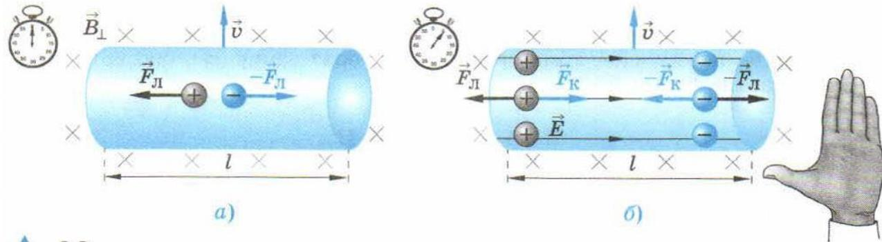
В проводнике, движущемся в магнитном поле, возникает разность потенциалов, или ЭДС индукции:
