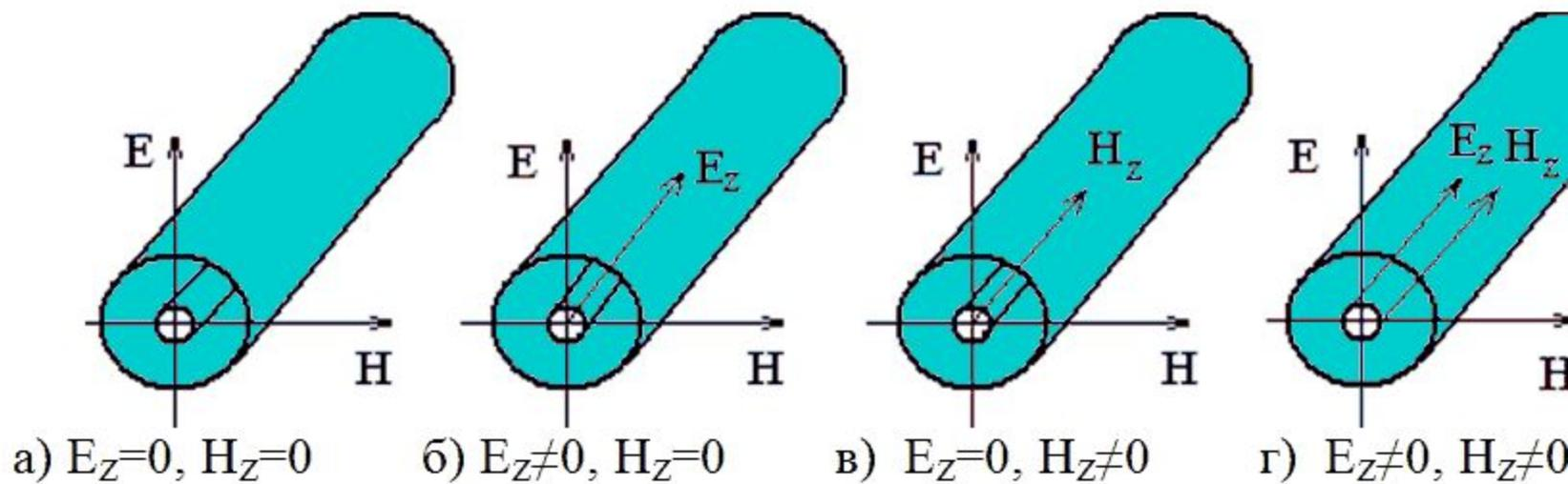
а - поперечная; б - электрическая; в - магнитная; г - гибридная
